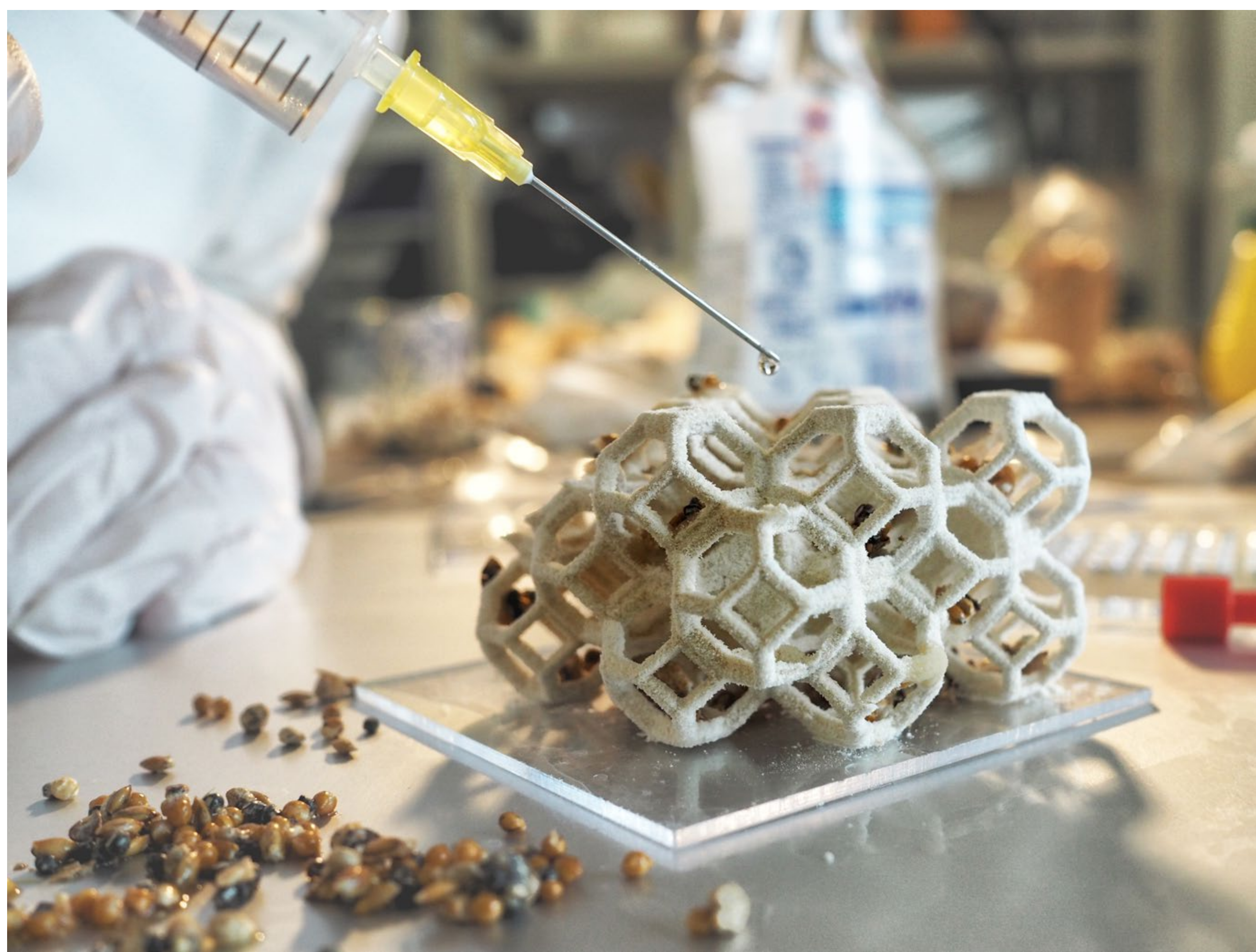
Einbringen von Myzelsporen in die sterile Raumstruktur aus Zellulose, damit Myzelgeflechte die Struktur durchdringen stabilisieren. (Fotografin: Isabel Kovacevic)
